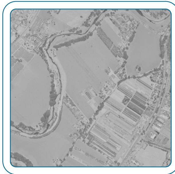
Una visualizzazione dei dati di Intensità registrati dal sensore LiDAR
