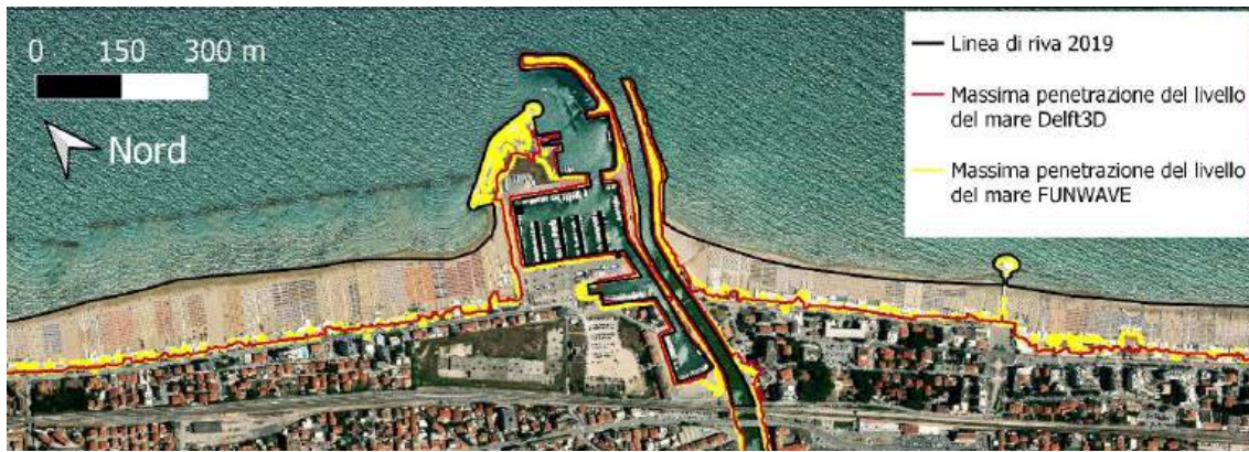
Figura A2.81: Massima penetrazione del livello del mare a seguito di una mareggiata con Tr=100 anni nel 2070: la linea rossa rappresenta il risultato della simulazione Delft3D; la linea gialla il risultato della simulazione FUNWAVE. La linea nera rappresenta la linea di riva aggiornata al 2019.
