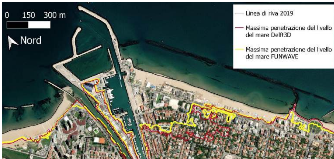
Figura A2.82: Massima penetrazione del livello del mare a seguito di una mareggiata con T_r=100 anni nel 2070: la linea rossa rappresenta il risultato della simulazione Delft3D; la linea gialla il risultato della simulazione FUNWAVE. La linea nera rappresenta la linea di riva aggiornata al 2019.
